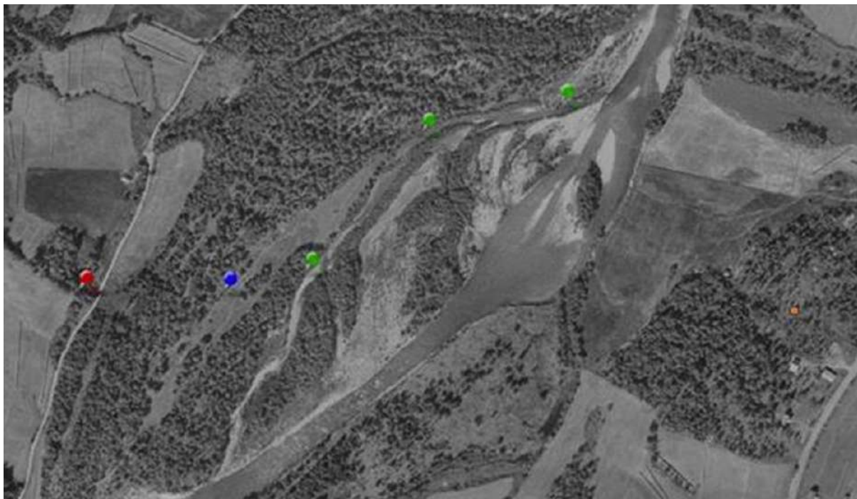
Figur 21. Historisk flyfoto fra 1958 viser at store deler av den aktuelle bekken var del av et sideløp til Driva. Rød markering indikerer ca. vandringsbarriere, blå markering der den i dag krysser under jordet (se figur 22) og grønn markering der den i dag fremstår som svært stilleflytende. Foto: www.finn.no
