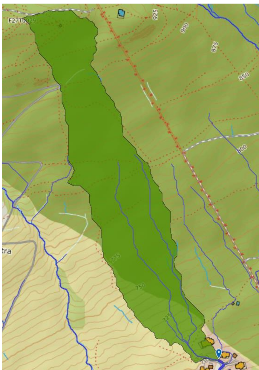
Figur 3: Analyse av overflateavrenning i Scalgo med en Flow Network Detail på 1.00 ha. De to dreneringslinjene i nedbørsfeltet stemmer godt overens med flombekk 1 og 2.
