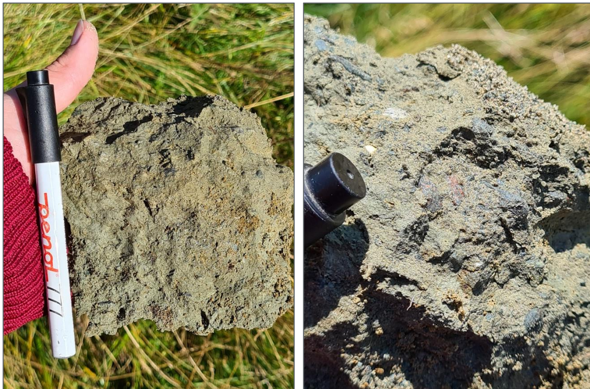
Figur 6: Nærbilde av den faste morenen fra bunnen av prøvegropen i posisjon 2. Veldig fast materiale med stein og grus omgitt av en siltig/sandig matriks. Den faste morenen i posisjon 3 var tilsvarende som denne.
