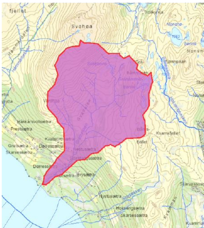
Figur 24 Nedbørsfelt for Grøtbekken ved nedre kryssing
